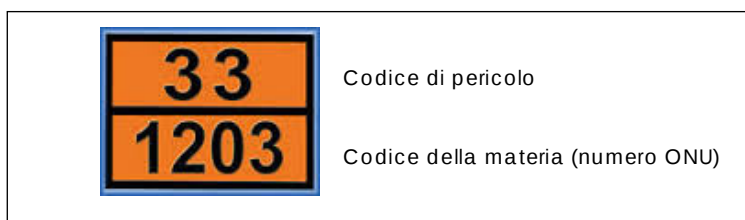
PANNELLO DEI CODICI DI PERICOLO
